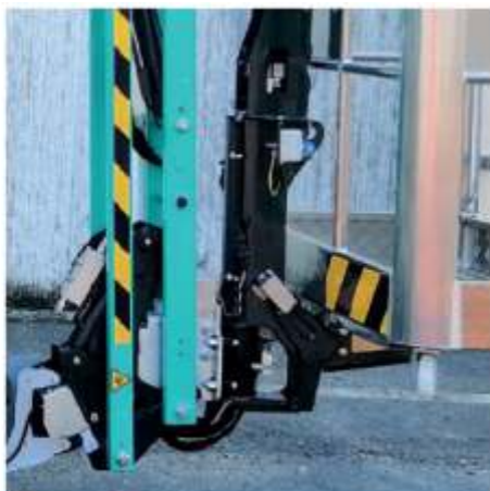
Compactitatea ansamblului brațului care găzduiește atât celula de sarcină, cât și sistemul de rotație al coșului.
